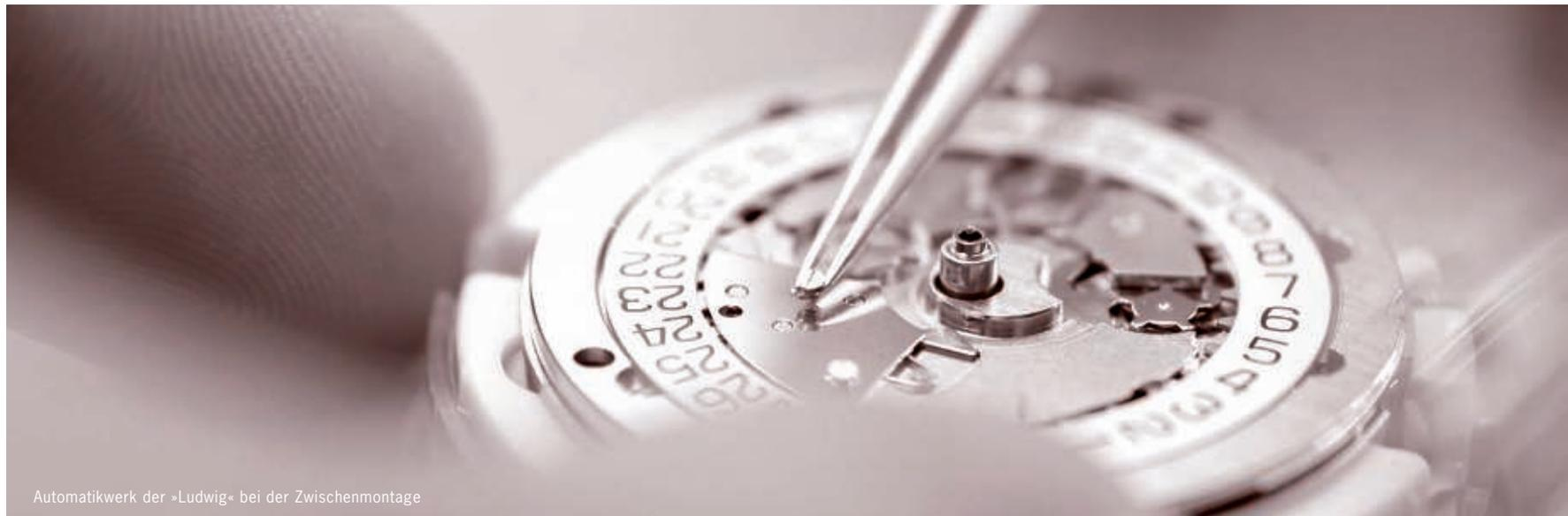
Automatikwerk der »Ludwig« bei der Zwischenmontage
